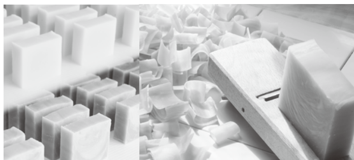
固形ソープをカンナで削り1枚使い切りタイプへ
